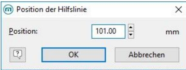
Die Hilfslinie hat dieselbe Ausrichtung wie das vorher ausgewählte Lineal. Die Hilfslinien lassen sich nachträglich verschieben. Hierzu klicken Sie mit der rechten Maustaste auf die Hilfslinie und gehen dann auf Position.
