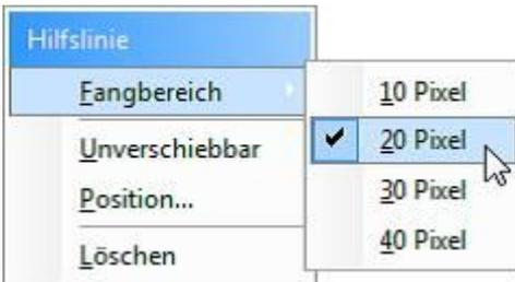
Eine "Fang-Funktion" hilft, Objekte genau auf die Hilfslinien zu legen. Die Objekte werden dadurch nicht dauerhaft mit der Hilfslinie verbunden, diese helfen lediglich bei der Positionierung von Objekten.
